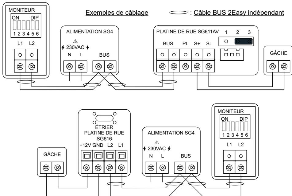
Les opérations de câblage/décâblage doivent être faites impérativement **HORS TENSION**.
