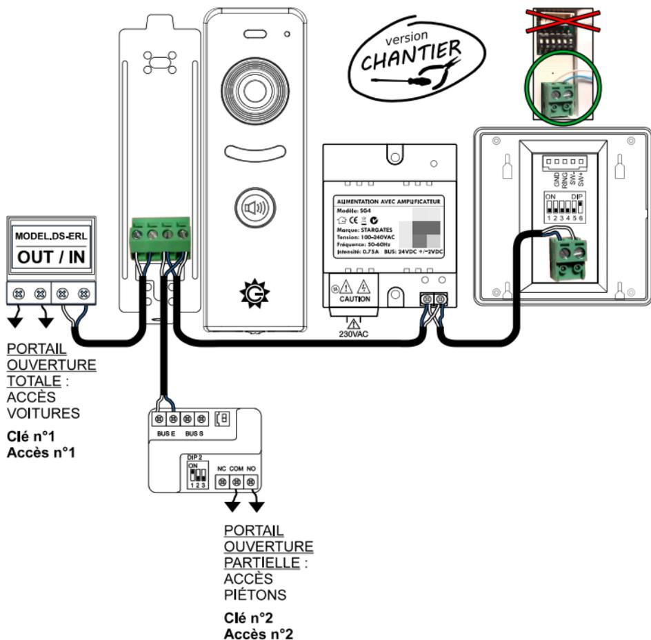
Câblage **BUS 2 FLS NON POLARISÉS.**
