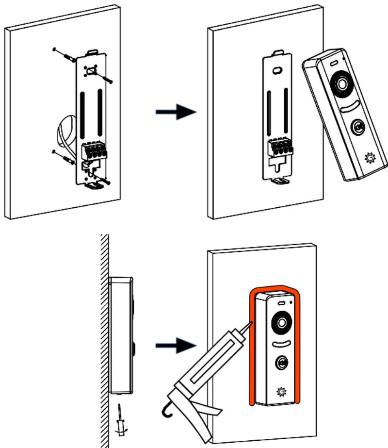
**ATTENTION** : Afin d'obtenir de meilleures performances d'étanchéité, veuillez appliquer un cordon de mastic silicone entre la platine et le mur après installation.
